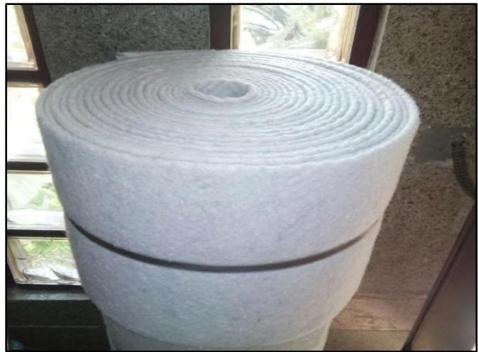
ژئونت‌ها با توجه به قابلیت جریان دهی مناسب آب، پایداری در شرایط مختلف شیمیایی، مقاومت در برابر هوازدگی، ساخت راحت و قیمت ارزان، محصولاتی بسیار مناسب برای زهکشی بوده و تقریباً در تمام سازه‌های ژئوتکنیکی که نیاز به زهکشی می‌باشد، کاربرد دارند. این ژئودرین‌ها به طور گستردگی در سیستم زهکشی فونداسیون‌ها، دیوارهای حائل، کوله‌پل‌ها، لاغون‌ها، راه و راه آهن‌ها کاربرد داشته و جایگزین مناسبی برای مصالح زهکش سنتی می‌باشند.
