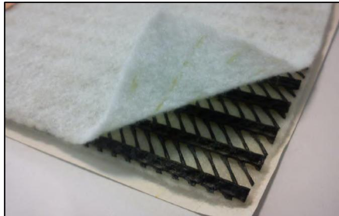
نقش این ژئوتکستایل‌ها فیلتر و جداکننده می‌باشد. اتصال ژئونت به ژئونت باید به طور مناسبی انجام شود. در صورتی که از چسب جهت اتصال استفاده می‌شود باید دقیق شود که مقدار اضافی چسب به کار گرفته نشود زیرا باعث بسته شدن شبکه‌های ژئونت می‌گردد و عملیات زهکشی را با اختلال رو برو می‌کند.
